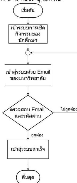
ภาพที่ 4.3 แผนภาพผังงานขั้นตอนระบบจัดการ การเข้าสู่ระบบ
