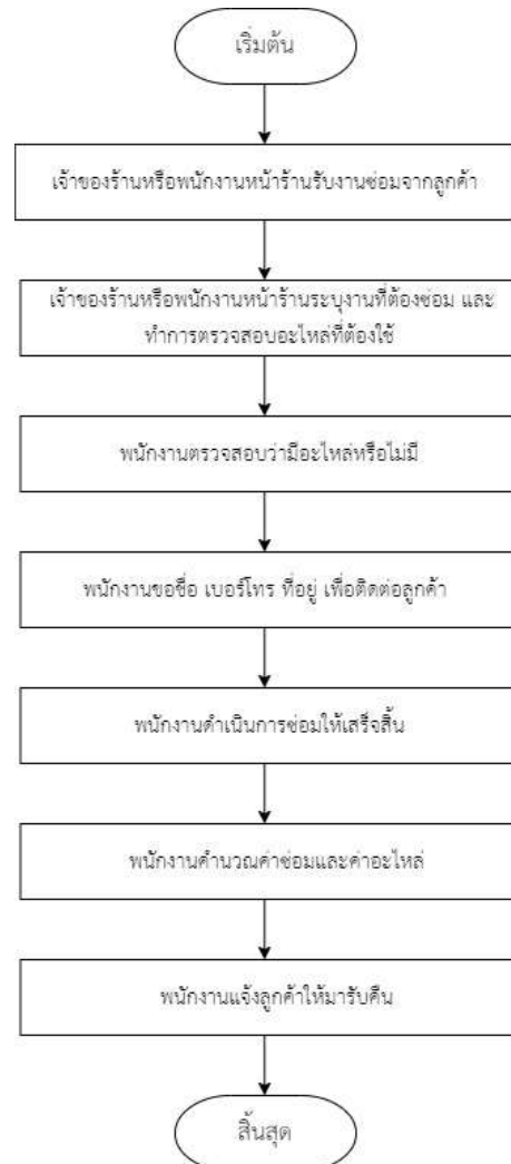
ภาพที่ 3.1 ขั้นตอนการดำเนินงานสำหรับกระบวนการให้บริการการซ่อมบำรุง
