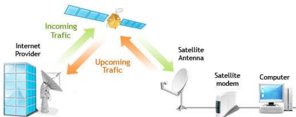
รูปที่ 2.4 การเชื่อมต่อสัญญาณอินเทอร์เน็ตผ่านดาวเทียม
