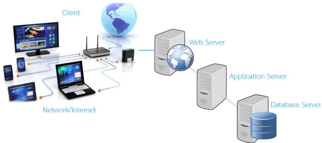
รูปที่ 2.14 แสดงการทำงานของไคลเอ็นต์เซิร์ฟเวอร์เทียร์ (Client-Server Tiers)
