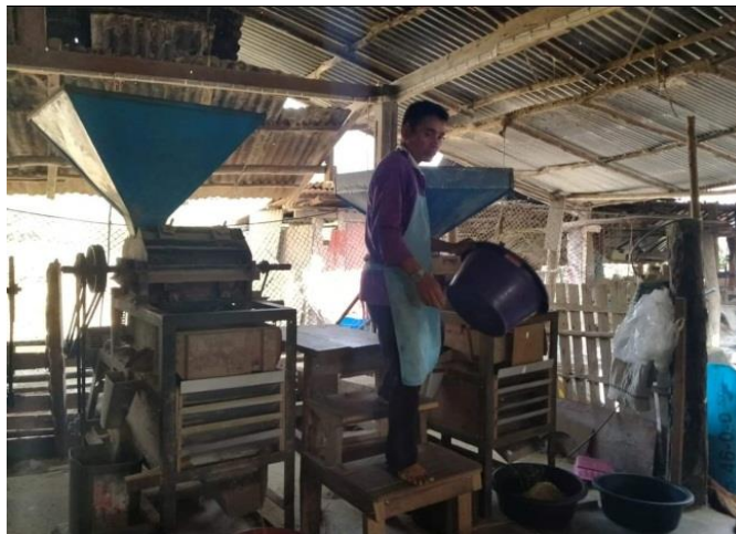
ภาพที่ 4.3 นำข้าวที่ตำเสร็จแล้วไปใส่เครื่องร่อนกลบ
